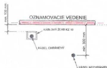
KRIŽENIE TELEKOM. KÁBLA S OZNAMOVACÍM KÁBLOM
